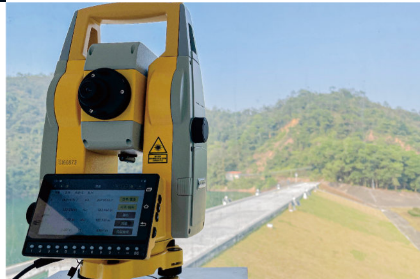
江门水库边坡自动化监测项目
