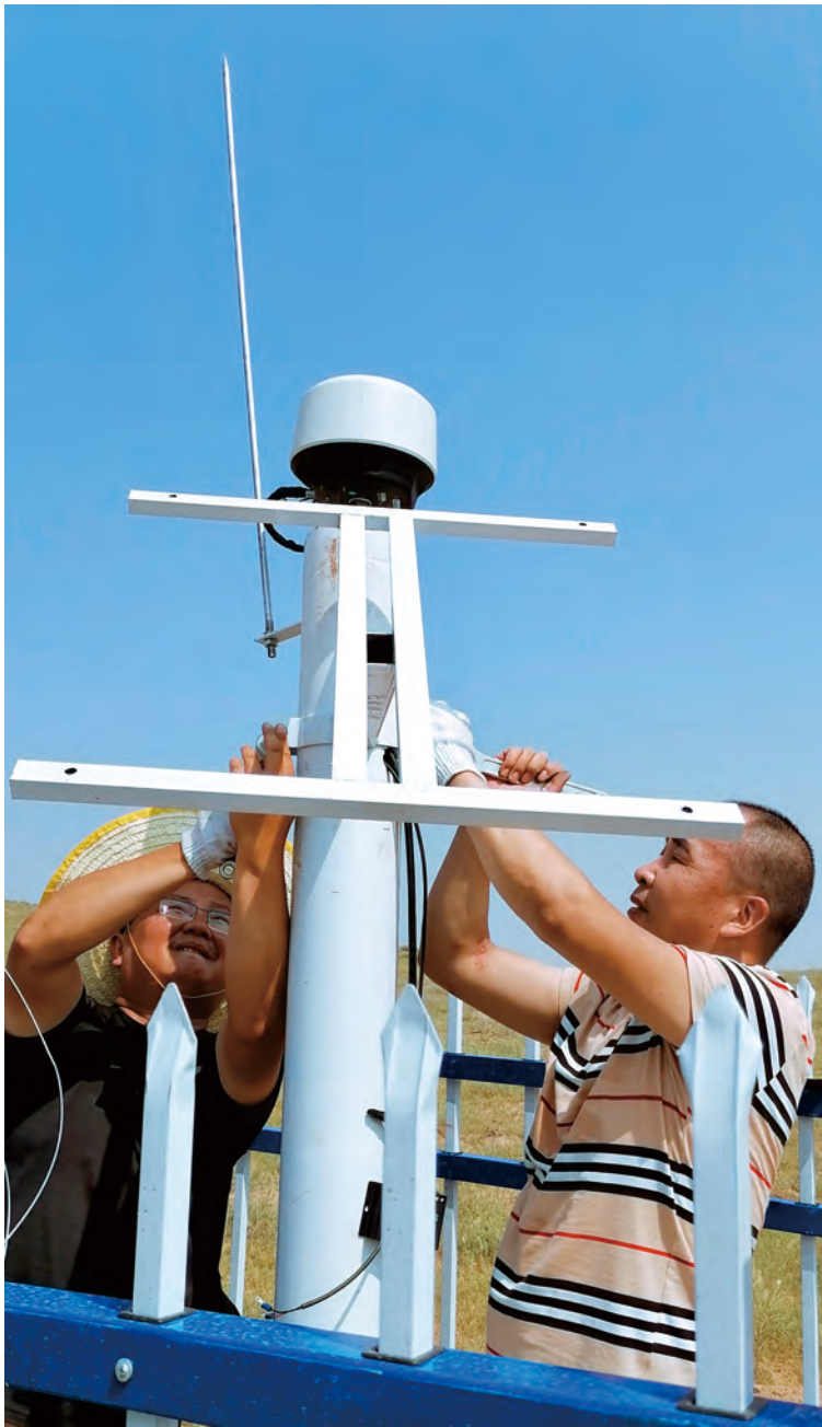
2022年,宁夏银川市宁东镇羊场湾煤矿采矿区建设十台监测站,进行地表变形自动化监测。
