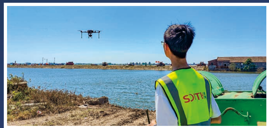
无人机搭载雷达流速仪、激光雷达等设备不间断测量流速、水位
