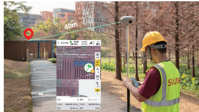
AR长焦辅助激光瞄准自动测量（40m）
