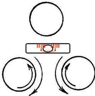
②将仪器旋转  $90^\circ$ ，使其垂直于角螺旋 A、B 的连线。旋转角螺旋 C，使管水准气泡居中。
