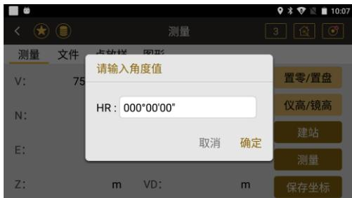
●置零/置盘界面，HR：输入水平角度值
