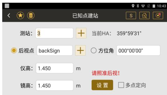
◆测站：输入已知测站点的名称，通过[+]可以调用、新建一个已知点或 GNSS 采集一个点作为测站点
