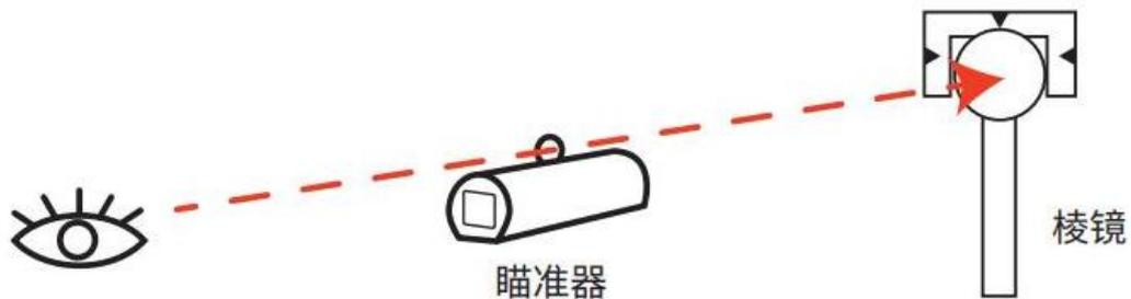
③利用望远镜调焦螺旋使目标成像清晰。当眼睛在目镜端上下或左右移动发现有视差时，说明调焦或目镜屈光度未调好，这将影响观测的精度，应仔细调焦并调节目镜筒消除视差。
