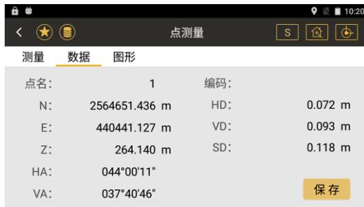
③按下“图形”键显示当前坐标点显示的图形，当前图形显示可配合底图作参考，显示已知点信息和全站仪方位情况。（注：因定向方法不同，任意建站或免控建站情况下，仅作点位间位置参考与底图叠加及指向信息需归算后才能确定）
