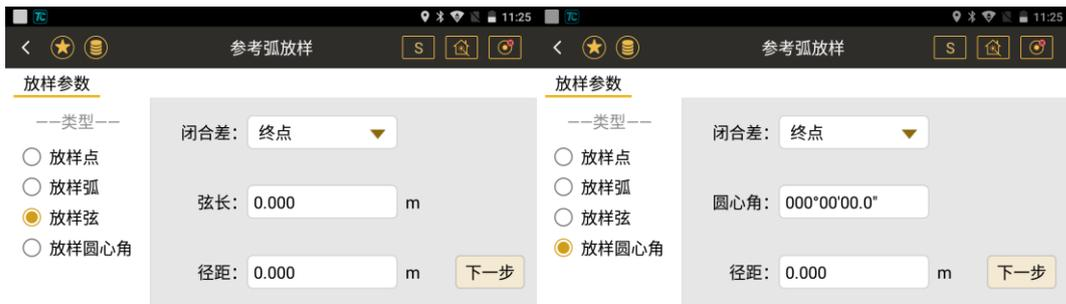
◆**径距**：在圆弧上一点到圆心的方向上，基于该点向圆外偏移径距为正，向圆内偏移径距为负。
