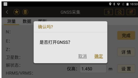
④输入仪器高和棱镜高，点击设置，完成任意建站。“校准后视”功能是确定后视点方向的功能，可以在建站前进行校准也可以建站后。
