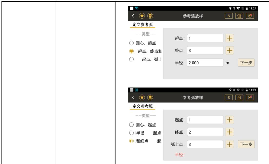
②输入该段圆弧的数据，完成参考弧的定义后，单击【下一步】。
