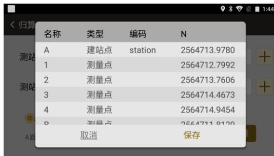
测站 A：作业时通过超站仪 GNSS 采集或用全站仪结合 RTK 打点时采集的第一个建站点坐标
