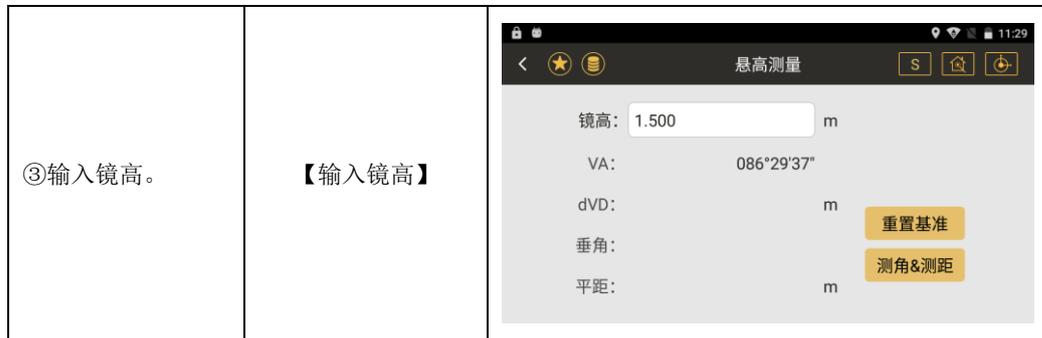
④在镜高一栏输入棱镜高度,将镜头对准棱镜,按下“测距&测角”按钮,得出高度、垂角和平距的信息。
