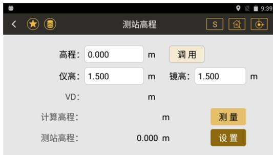
◆ 高程：输入已知点高程，可以通过调用得到已知点的高程
