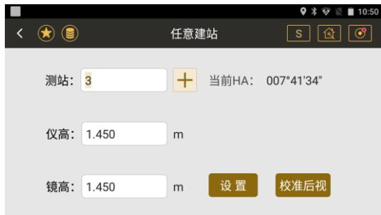
※1) 目前后视点的坐标未知，方位角未知，因此方位角和测量点的坐标并不是最终坐标（临时坐标中的坐标）
