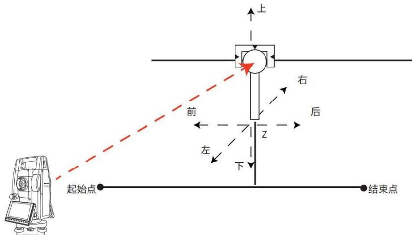
●通过两个已知点，及输入待放样点在这条直线上基于起点的前后、左右、上下偏移值后计算出放样点的坐标。
