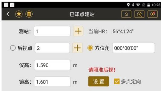
多点定向是利用三个或三个以上已知点定向 同时也能利用这些点的高程来确定测站高程（定向及传递高程），在需要进行较高精度的测量/放样时，为了提高建站精度使用的建站方法，操作流程与后方交会类似，都是后视多个已知点，差别在于建站点的坐标一个是已知的，一个是未知的。
