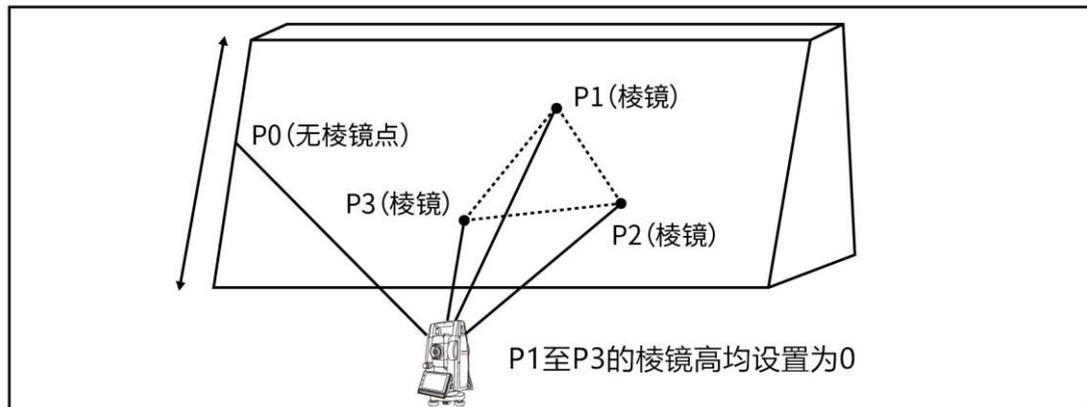
●上面图中的三个棱镜点确定一个平面，而无棱镜点为任意点
