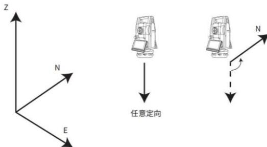
任意建站采用的是先建站后定向的作业方式,通过 RTK 或超站仪采集的建站点坐标建立一个坐标北方向待定的独立坐标系,在完成采集作业后,补采后视点坐标完成定向。步骤为利用一个未知坐标点进行定向(设置),建站完成后在此测站采集的点数据需进行归算,进行归算需要获取后视点的坐标。(当使用超站仪时,建站点和后视点坐标都可以由超站仪 GNSS 模块测量所得;全站仪使用该功能时需要搭配 RTK 使用,用 RTK 采集建站点和后视点坐标)
