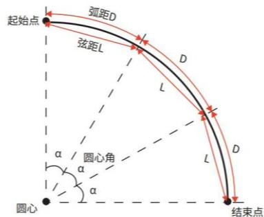
●参考弧适用于轴线为弧的测量放样,弧的定义是通过圆心加半径,或圆心加上圆上的一点,或者弧所在圆上的三点这几种方式。参考弧的方向为顺时针方向即 P1 到 P2 为顺时针。参考弧的偏移是按照弧距、弦距、径距等确定放样点在弧上投影的位置和放样点位于弧内、弧上或弧外。
