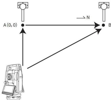
点到直线建站是通过测量空间中的一条直线，定义该直线的起点为坐标原点，起点到终点的方向为坐标北方向，建立一个独立坐标系，在通过建站点的几何关系完成建站。适用于在施工过程中借助直线桥或直线隧道的几何特点建立一个坐标系，方便施工放样。
