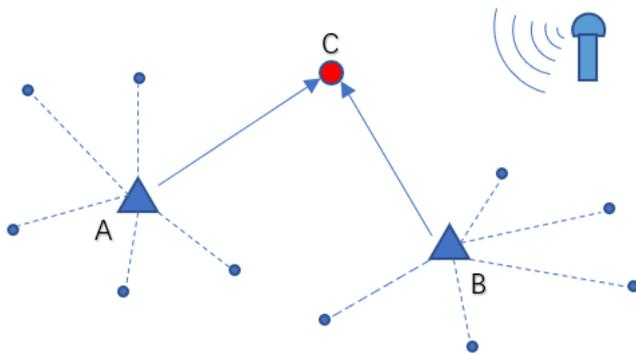
免控建站是根据超站仪可以实时获取测站点坐标信息的功能进行设计的建站功能，该建站功能也能通过 RTK 与全站仪联动使用实现，该建站功能的原理为在测区内的合适地方架设超站仪，利用 GNSS 采集获取架站点 A 坐标，开始碎部测量，同时测量公共点 C。到下一架站点 B 并利用 GNSS 采集获取坐标，继续碎部测量，同时测量公共点 C，最后利用软件“归算”功能，将 A、B 两个测站所测碎部点的坐标进行校正。
