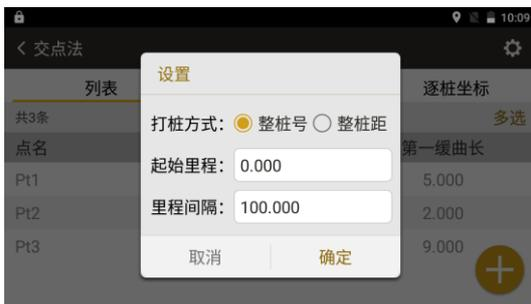
◆ 打桩方式：选择道路打桩方式为整桩号或整桩距
