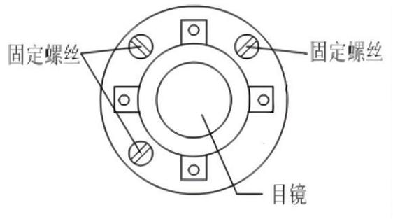
2、用螺丝刀均匀地旋松该四个固定螺丝，绕视准轴旋转分划板座，使 A' 点落在竖丝的位置上。
