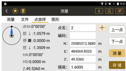
◆dHA：测距头指向与放样点方向在水平面上的夹角
