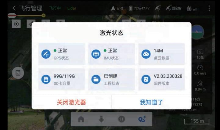
b. 飞机遥控器实时查看激光状态，自动化控制激光雷达和POS启停。
