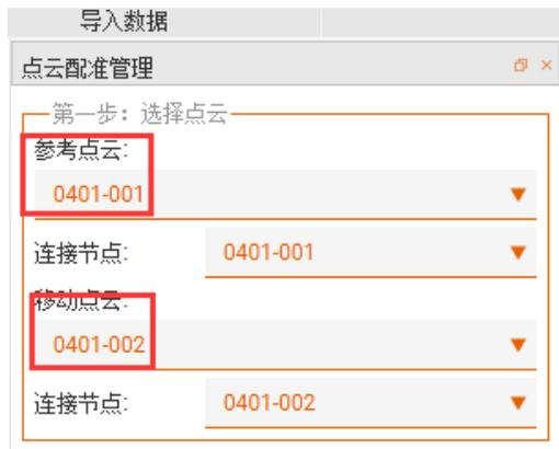
图 3.5-21 选取对应参考点云和移动点云
