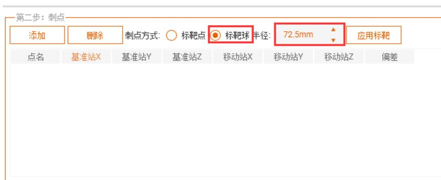
图 3.5-39 选择刺点方式（注：标准靶球半径为 72.5mm）
