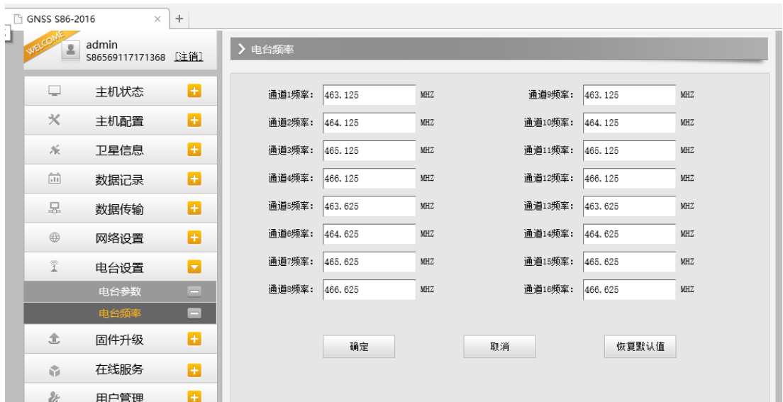
图 2.4-31 Web UI 电台设置-电台频率
