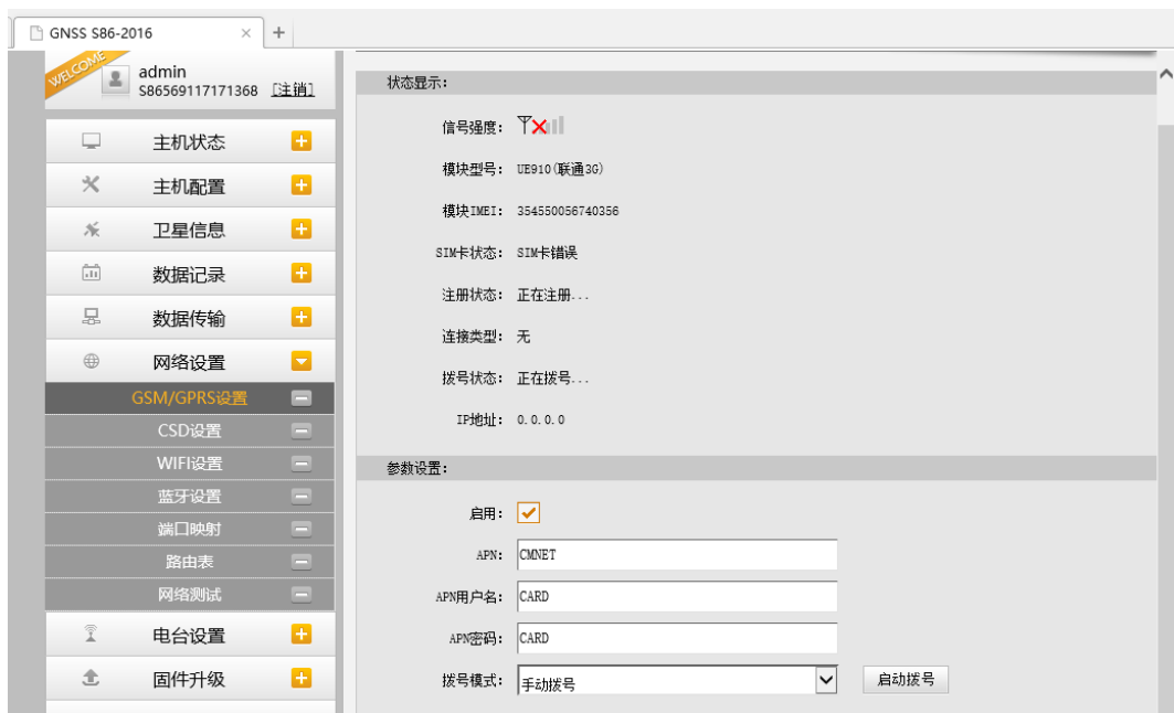
图 2.4-22 Web UI 网络设置-GSM/GRPS 设置
