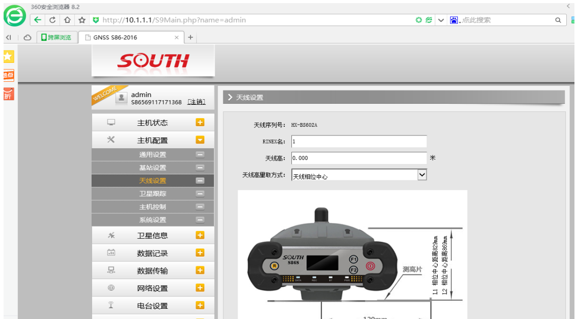
图 2.4-8 Web UI 主机配置-天线设置
