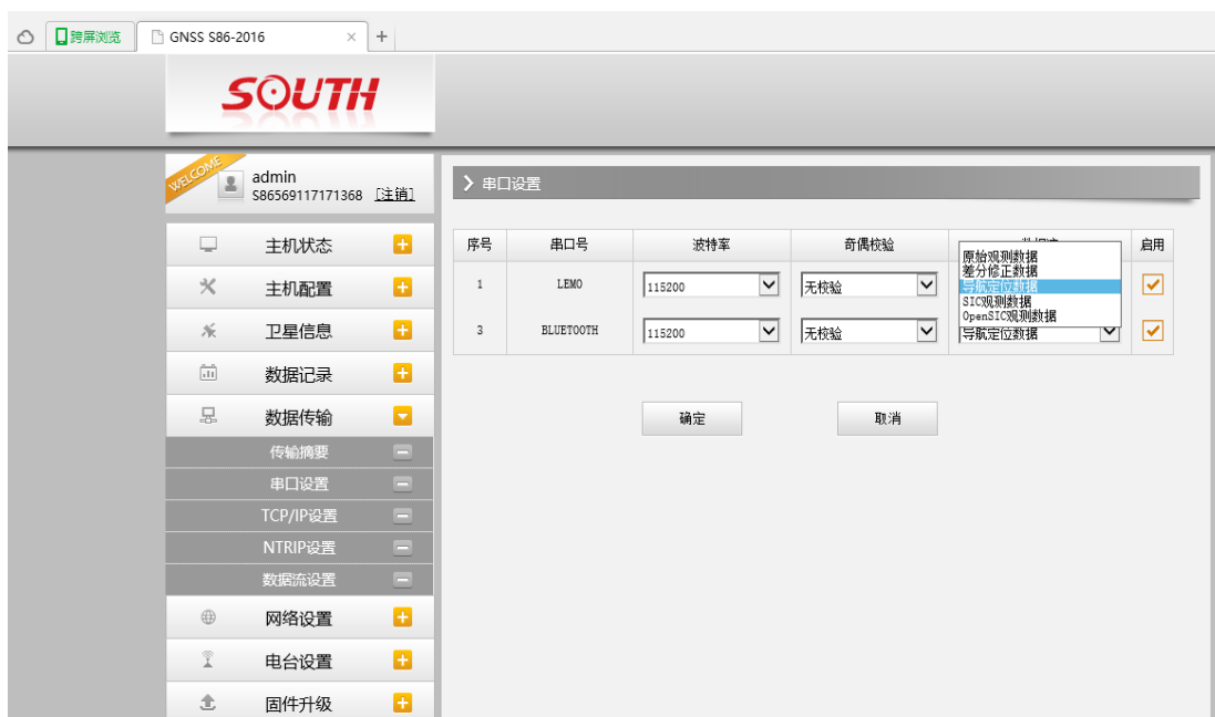
图 2.4-17 Web UI 数据传输-串口设置
