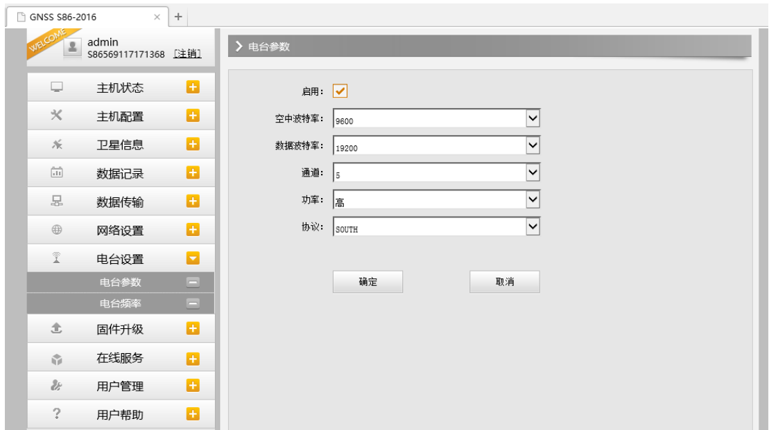
图 2.4-30 Web UI 电台设置-电台参数
