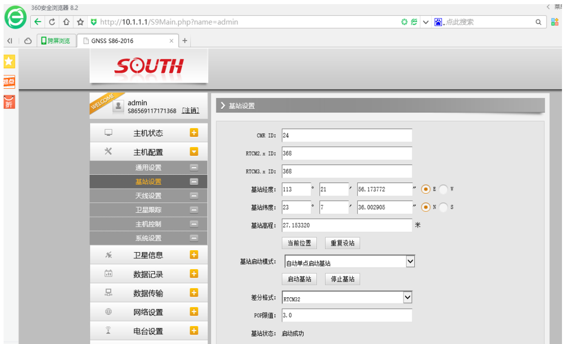
图 2.4-7 Web UI 主机配置-基站设置
