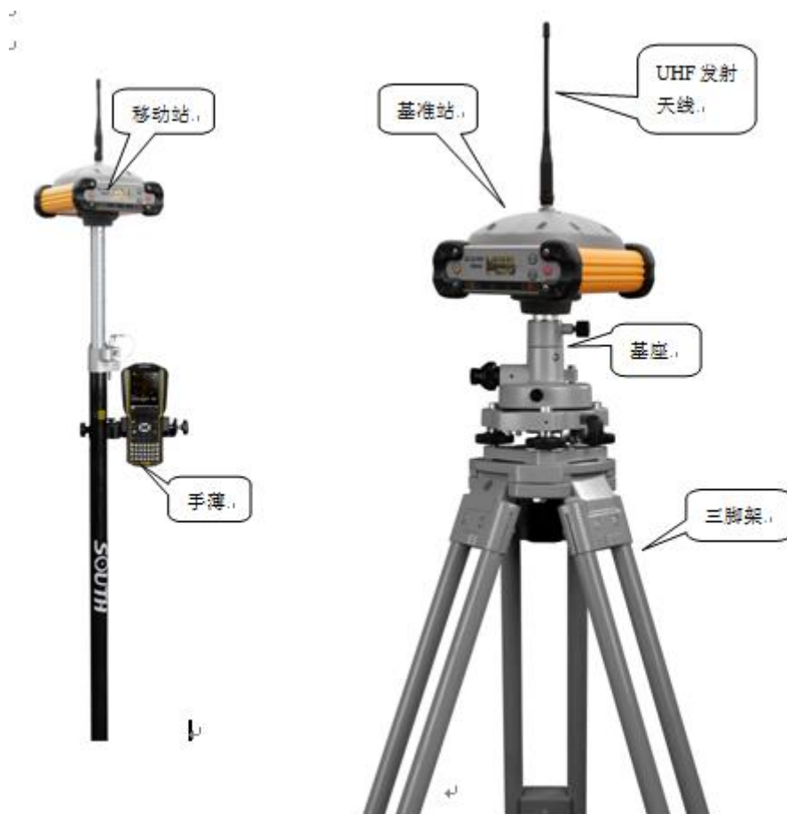
S86 测量系统示意图
