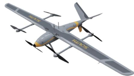
整机采用固定翼与多旋翼相结合的方式，高度发挥了两方优势。多旋翼设计可垂直起降，固定翼设计使得该款无人机航程大、巡航速度快，可快速完成大面积航测任务，满足山区、丘陵、高原等复杂地形区域作业要求。同时搭配地面站软件，只需完成航线规划，无人机即可自行完成数据采集、飞行状态转换、垂直起降等各飞行阶段。
