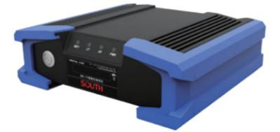
SDE-19测深仪，具有单频和双频两个版本，内置网页，可进行参数配置，实时查看水深数据。应用于无人船等设备集成，也可以配合南方的无人船软件，是南方新研制的一款小巧、携带方便、操作简单的便携式测深仪。自由行测量软件和控制采集软件应用于江河、湖泊、近海等水域进行精密水深测量，让水深测量更加轻松。
