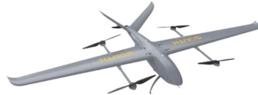
纯电动垂直起降固定翼无人机、立足于长航时，大载重，一机多用，操作便捷，一键起飞，支持仿地飞行，最大载重10KG，灵活切换搭载，包括航测模块、激光模块、双光吊舱模块等。配备专业地面站控制系统，智能化完成数据采集、飞行状态转换、垂直起降等操作，广泛用于测绘、国土、交通、电力、数字城市等行业领域。
