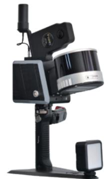
RobotSlam测绘级SLAM扫描机器人采用SLAM技术（即实时定位与建图技术），可在室内外环境使用。作业员手持产品在走动中进行自身定位及增量式三维建图，从而获取周边环境的空间三维信息。该产品可不依赖于GNSS定位，直接获取室内外高精度空间三维信息，也可添加RTK服务，得到具有厘米级定位精度的空间三维信息。
